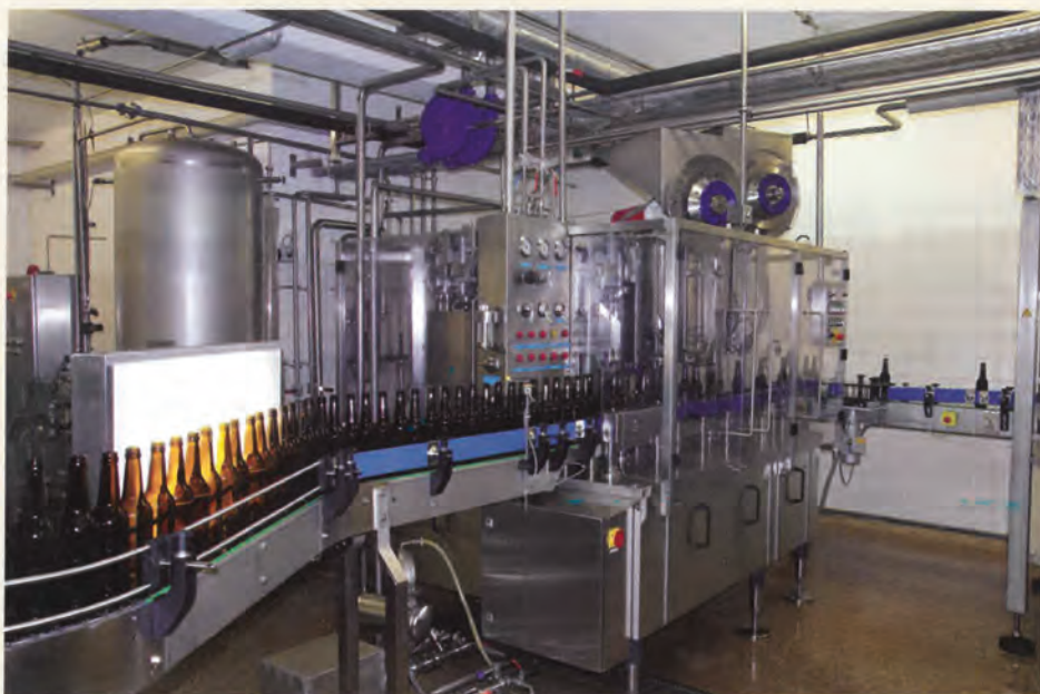
Langrohr-Gegendruckfüller mit 20 Füllventilen und je fünf integrierten Kronenkorkstempeln sowie Schraubköpfen
